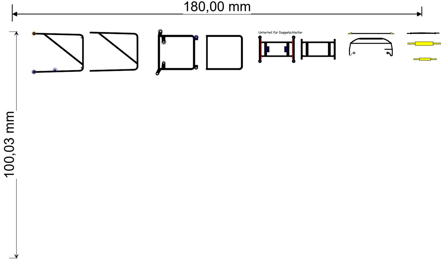
Hier erstmal die Konstruktion, die auf Overheadfolie gedruckt und mit dem Stahlmaßstab und Skalpell ausgeschnitten werden muß.
